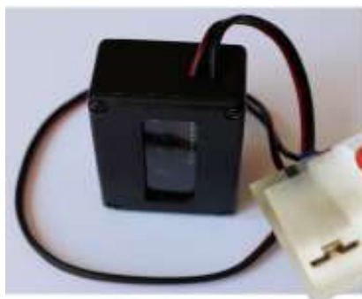
Transponderen måler 37x 53 x 22 mm. (B x H x D)
